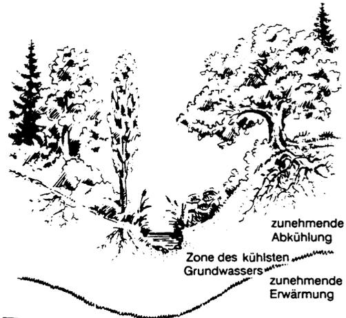
Abb.76: Abkühlung des Grundwassers nach Schauburger
